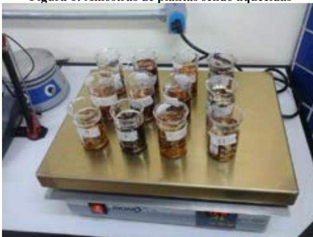
E após o resfriamento das mesmas, as amostras foram peneiradas e misturadas (individualmente) com ácido clorídrico (HCl) e ácido sulfúrico (H<sub>2</sub>O<sub>4</sub>) para analisar quais das amostras poderia ser um indicador natural de pH.
