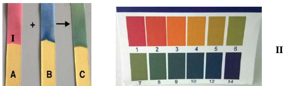
Figura 6: As colorações tomadas pelo papel indicador. A – solução ácida antes da reação; B – extrato aquoso da cinza antes da reação; C – solução depois da reação e II – escala de pH
