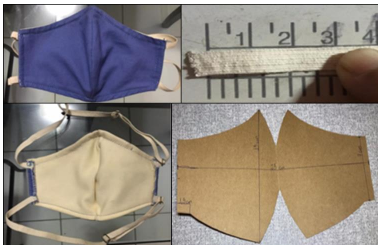
Figura 1: Protótipo construído pelos professores em formação inicial, sendo a parte azul o algodão e a branca, o Neoprene.
